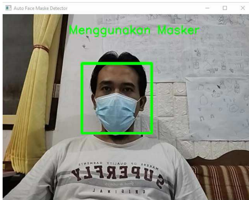
Gambar 13. Prototipe mendeteksi objek wajah yang memakai masker
