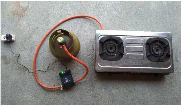
Gambar 16. Implementasi Sistem Proteksi Kebocoran Gas LPG
