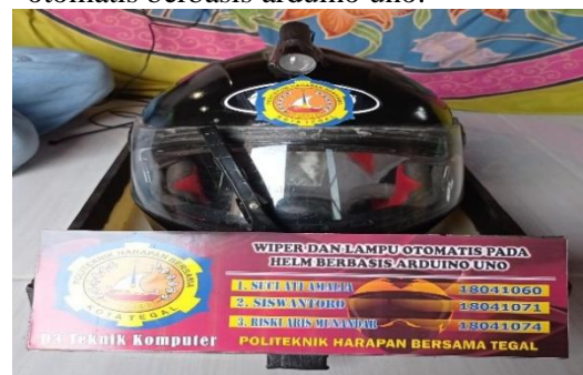
Gambar 5. Alat wiper dan lampu otomatis pada helm
