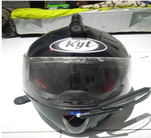
Gambar 5. 1 Tampilan wiper dan lampu otomatis pada helm
