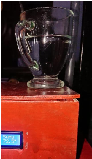
Gambar 8 Pengujian Sensor suhu pada air panas
