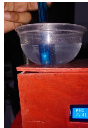
Gambar 6 Pengujian sensor pH pada air PDAM
