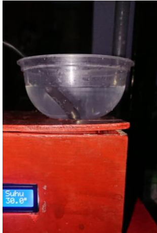
Gambar 7 Pengujian sensor suhu air pada air biasa
