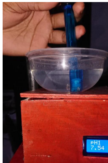
Gambar 5 Pengujian sensor pH pada air aqua
