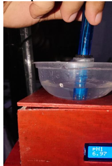
Gambar 4 Pengujian sensor pH pada air sumur
