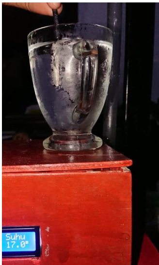
Gambar 9 Pengujian Sensor suhu pada air es
