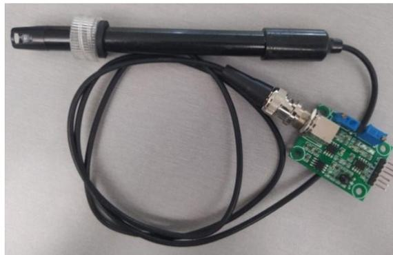
Gambar 2.1 Sensor pH 4502C
