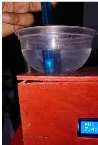
Gambar 5.4 Pengujian sensor pH pada air PDAM
