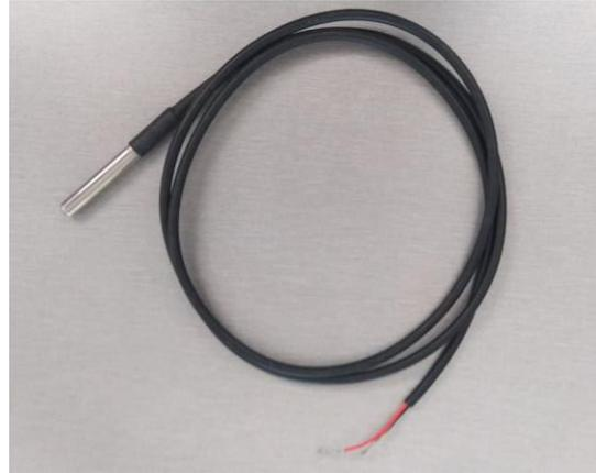
Gambar 2.2 Modul DS18B20 atau sensor suhu air
