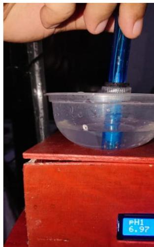
Gambar 5.2 Pengujian sensor pH pada air sumur
