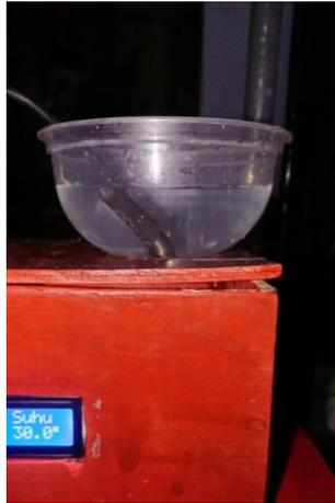
Gambar 5.5 Pengujian sensor suhu air pada air biasa
