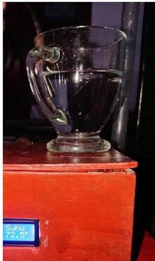
Gambar 5.6 Pengujian sensor suhu pada air panas
