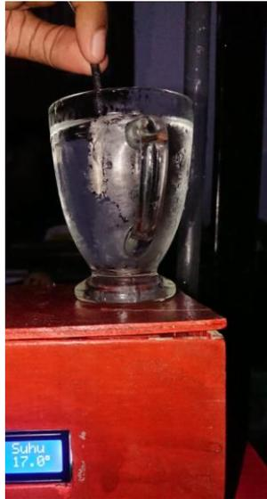
Gambar 5.7 Pengujian sensor suhu pada air dingin
