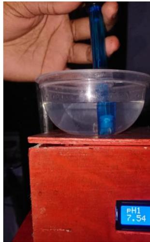
Gambar 5.3 Pengujian sensor pH pada air aqua
