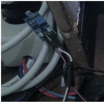
Gambar 4. Rangkaian Pemasangan Sensor Cahaya/LDR
