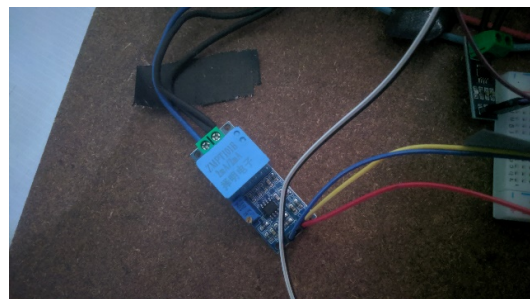
Gambar 3. Rangkaian Pemasangan Sensor ZMPT101B
