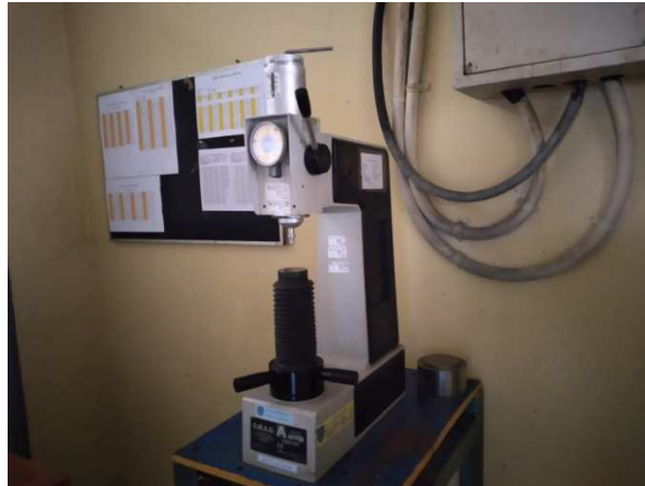
Gambar. 3.3 Alat Uji Kekerasan Affri 206 RT (Dokumentasi, 2021)
