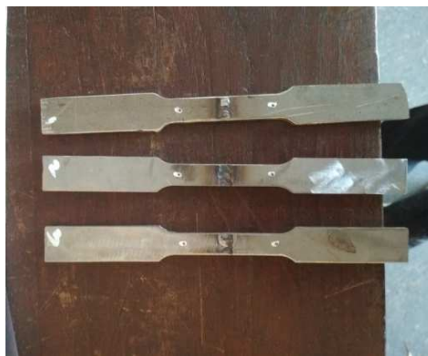
Gambar. 3.13 Specimen uji Tarik. (Dokumentasi,2021)
