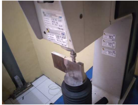
Gambar. 3.23 Uji daerah Logam induk. (Dokumentasi,2021)
