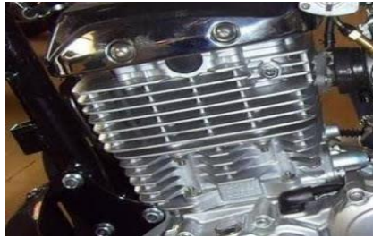
Gambar 2.20 Cylinder mesin menggunakan sirip. (Hardi W, 2020)
