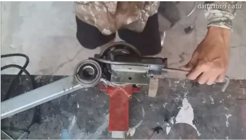
Gambar 6. Potong Besi Lalu Lengkungkan
