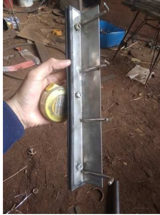
Gambar 4.6 Merakit Rubber , Plat, Dan Besi
