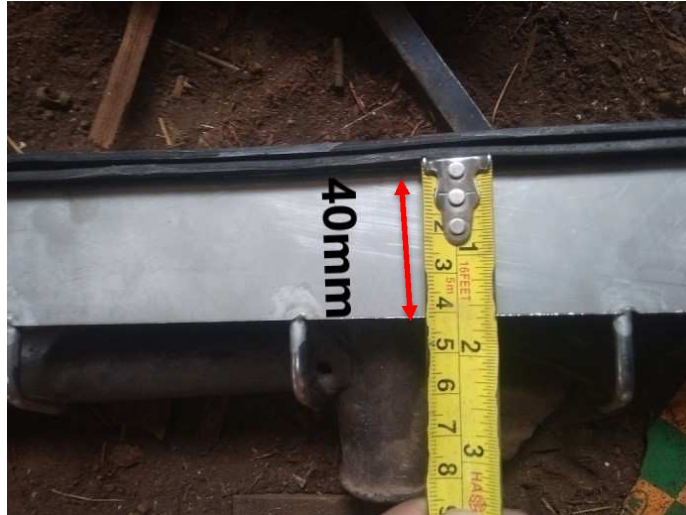
Gambar 4.22 Pengecekan Dimensi Penggaruk Tinggi 40 mm
