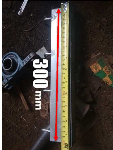
Gambar 4.20 Pengecekan Dimensi Penggaruk Panjang 300 mm
