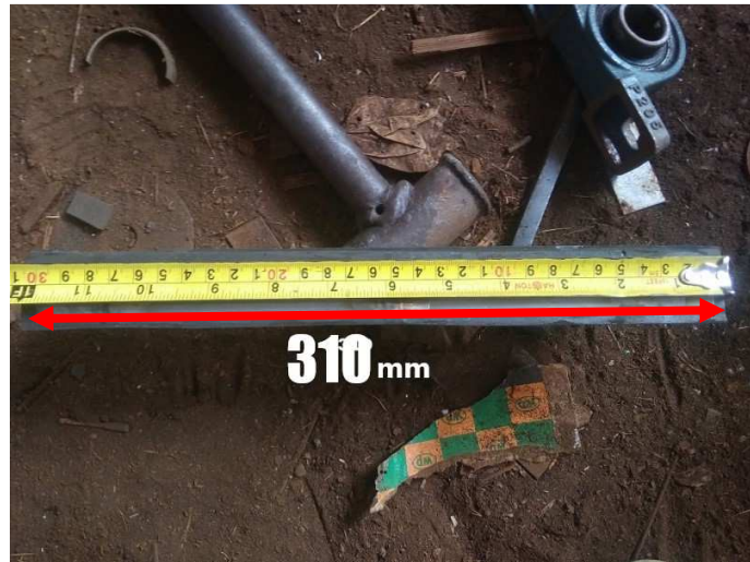
Gambar 4.17 Pengecekan Dimensi Rubber Panjang 310 mm
