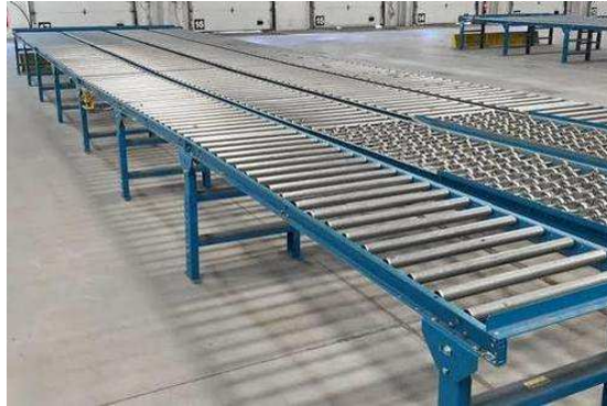
Gambar 2.10 Roller Conveyor (Pengadaan.web.id, 2021)
