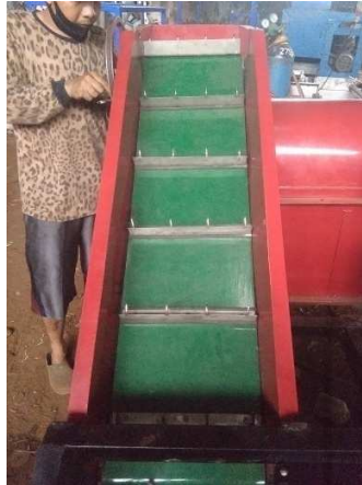
Gambar 4.8 Pasang Belt Pada Roller
