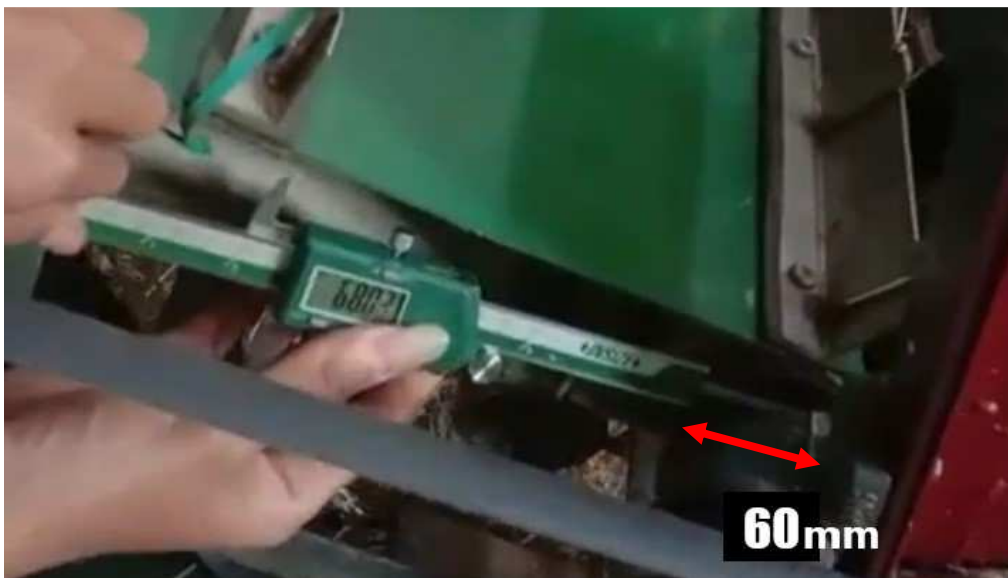
Gambar 4.12 Pengecekan Dimensi Roller Lebar 60 mm
