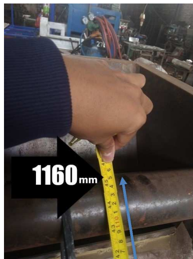
Gambar 4.15 Pengecekan Dimensi Belt Panjang 1160 mm
