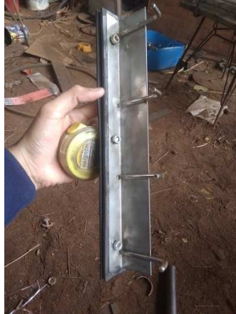
Gambar 4.4 Lengkungkan Plat Yang Telah Dipotong
