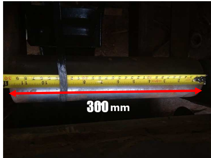
Gambar 4.11 Pengecekan Dimensi Roller Panjang 300 mm
