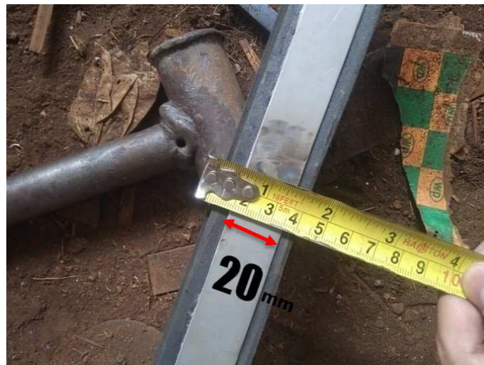
Gambar 4.21 Pengecekan Dimensi Penggaruk Lebar 20 mm
