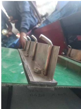
Gambar 4.7 Memasang Penggaruk Dan Rubber Pada Belt
