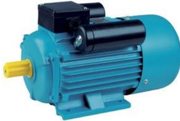
Gambar 2. 2 Motor Induksi Satu Fase (Prianto, 2010)
