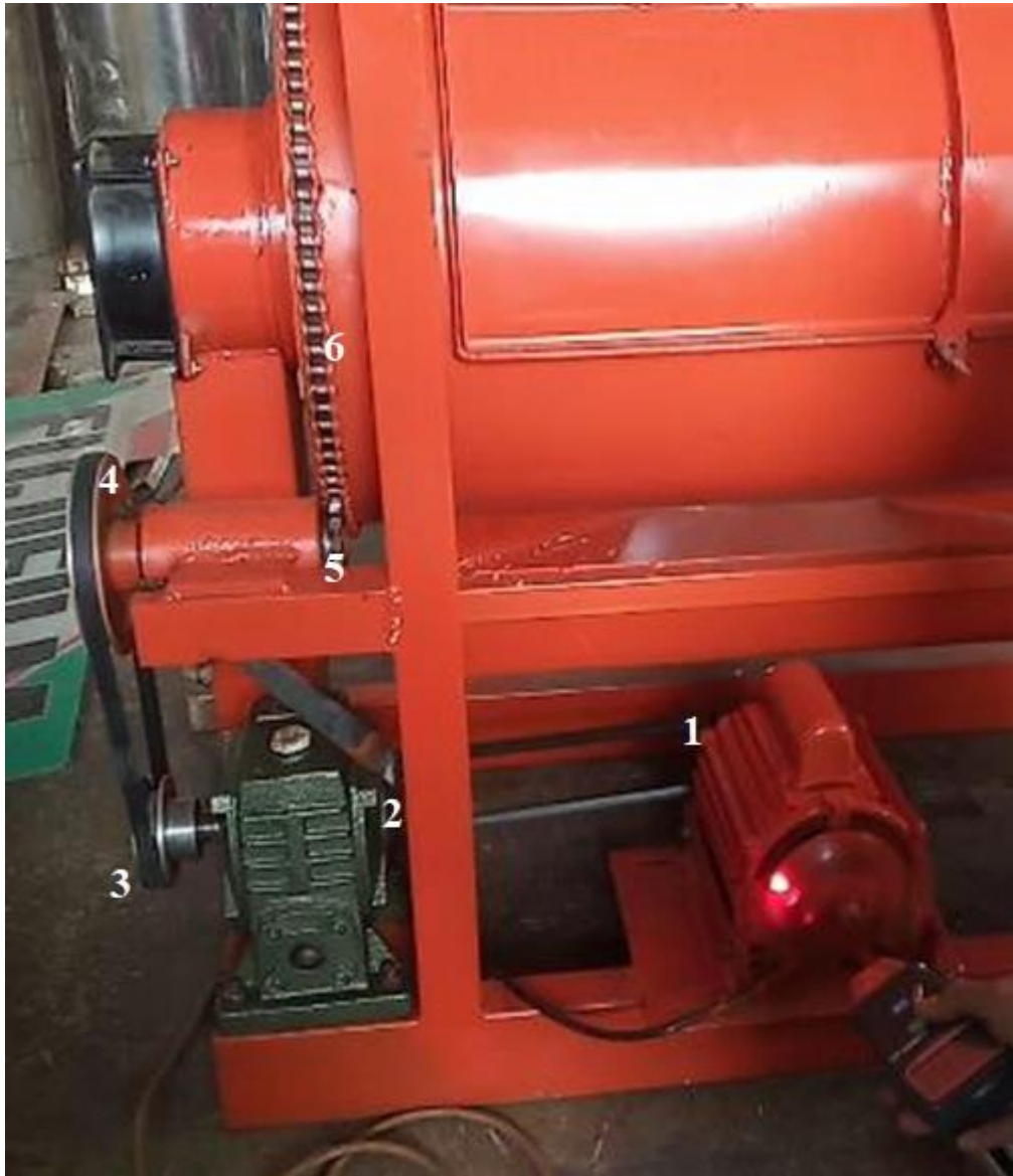
Gambar 4. 3 Gambar Sistem transmisi pada mesin pengering padi (Sumber, Dokumen)
