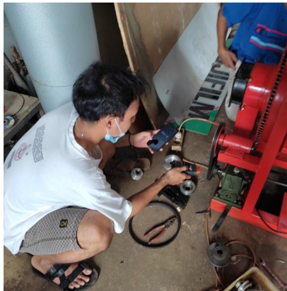
Lampiran 6 Mencari Rpm dengan Tachometer
