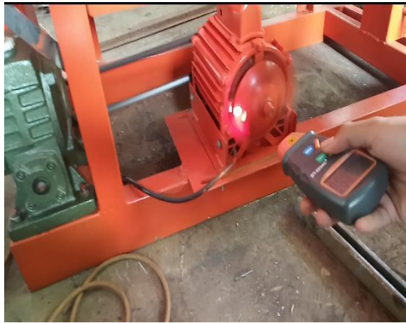
Gambar 4. 1 Uji kecepatan rpm maksimal tanpa beban
