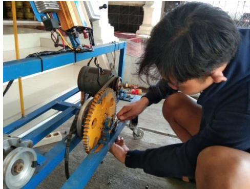
Gambar 3.13 Pemasangan ass penghubung dan pulley pada mesin (Dokumentasi, 2021)
