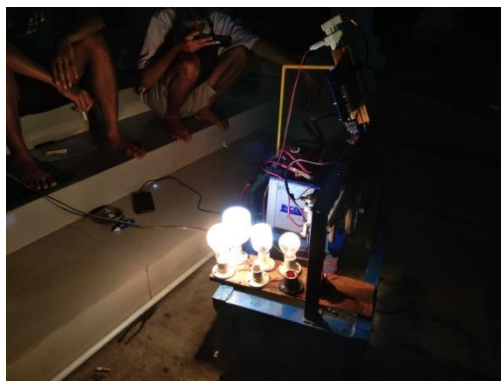
Gambar 3.20 Lampu menyala dengan beban 370 watt (Dokumentasi, 2021)
