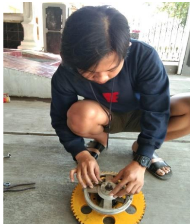
Gambar 3.12 Pemasangan pulley pada ass penghubung (Dokumentasi, 2021)
