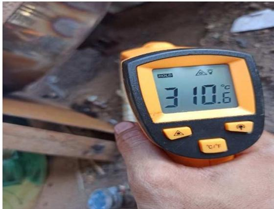
Gambar 4.5 Pengujian sampai suhu 310 °C menggunakan *thermogun* (dokumentasi 2021)
