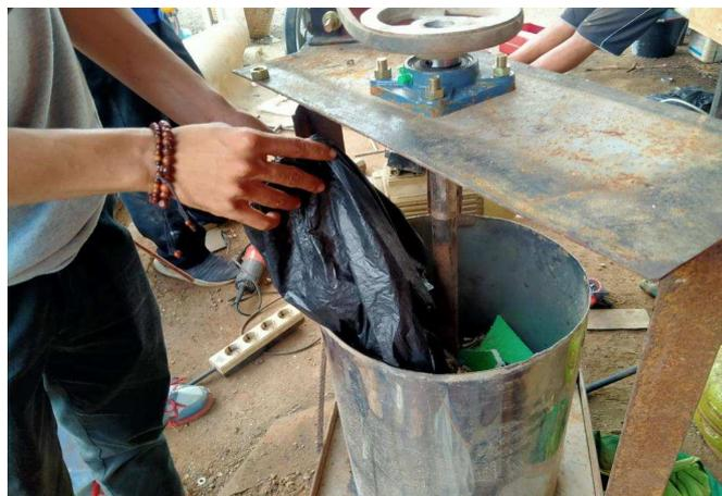
Gambar 3.5. Memasukan bahan ke tabung mesin *molding* (dokumentasi, 2021)
