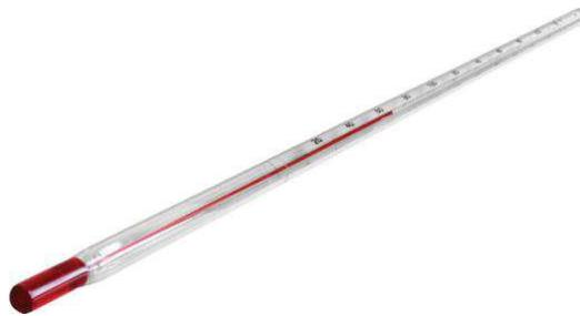
Gambar 2.4. *Thermometer* (Batara, 2011).
