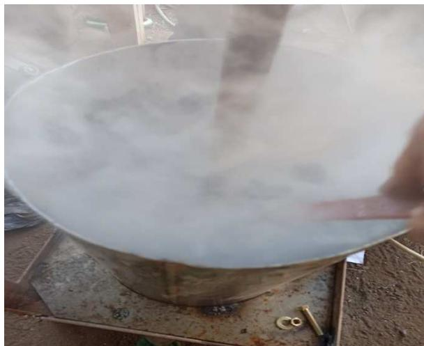
Gambar 3.6. Mengaduk semua bahan di tabung mesin molding (dokumentasi, 2021)
