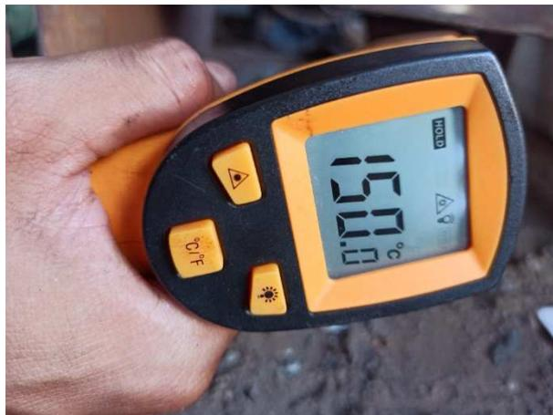
Gambar 4.1 Pengujian sampai suhu 150 °C menggunakan *thermogun* (dokumentasi 2021).
