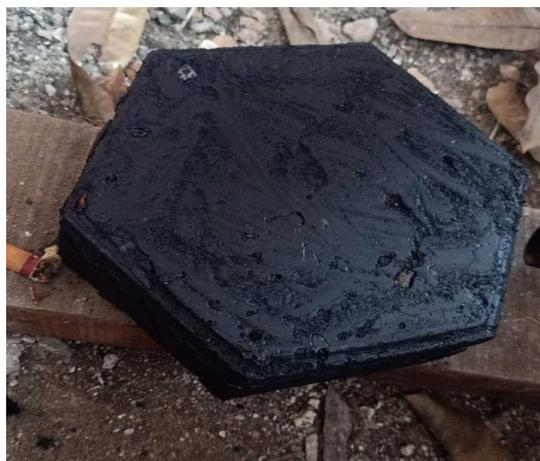
Gambar 4.6. Hasil pengujian suhu 310 °C (Dokumentasi, 2021)
