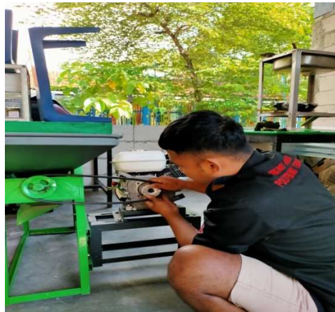
Gambar 4. 1. Pemasangan puli 2,5 inch (Dokumentasi, 2021)
