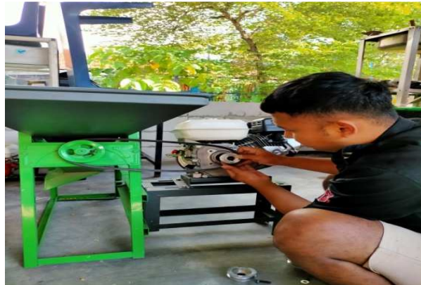
Gambar 4. 2. Pemasangan puli 2 inch (Dokumentasi, 2021)
