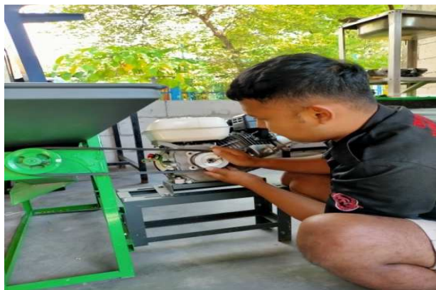
Gambar 4. 3. Pemasangan puli 3 inch (Dokumentasi, 2021)
