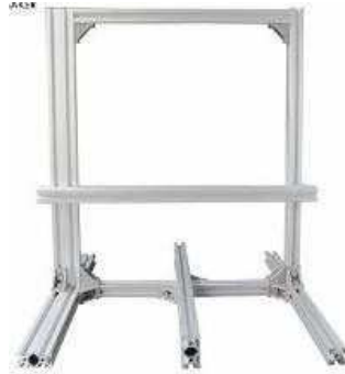
Gambar 2. 18 Rangka Mesin Cetak 3D
