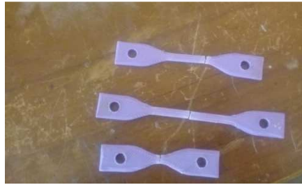
Gambar 4. 7 Specimen yang sudah di uji tarik
