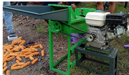
Gambar 2. 7 motor bensin dan spesifikasi mesin pemipil jagung ( Sumber : Dokumentasi, 2021 )
