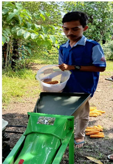
Gambar 4. 8 Pengujian jagung 1 kg ( Sumber : Dokumentasi, 2021 )
