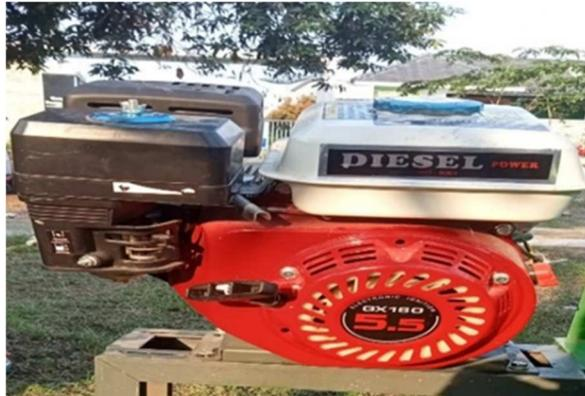
Gambar 3. 18 Mesin Diesel 5,5 PK
