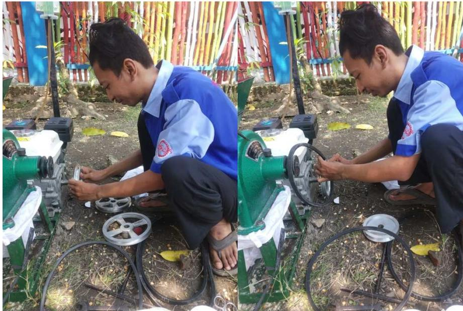
Gambar 3. 11 Pemasangan Puli 6 inch Dan Sabuk V
