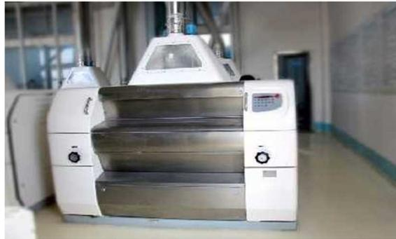
Gambar 2. 2 Mesin *Roll Mill*
