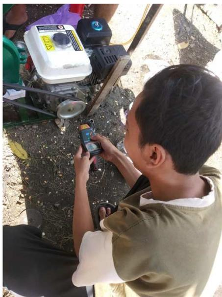
Gambar 3. 14 Pengukuran Rpm
