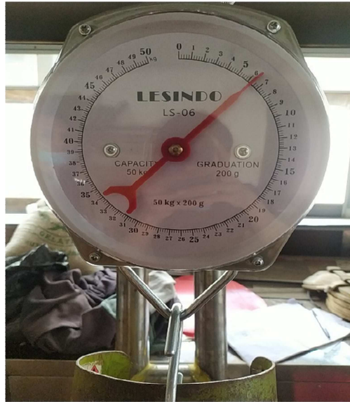
Gambar 3.22. Berat gas setelah digunakan untuk proses pengeringan
