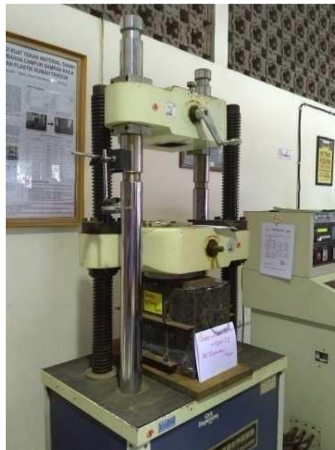
Gambar 3.2 Alat Uji Tekan Universal Testing Machine . (Dokumentasi.2021)
