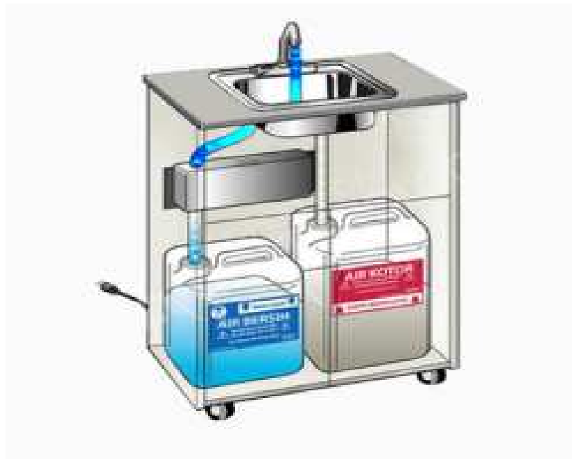
Gambar 2.2 Skema tempat input air bersih dan out put air kotor. (RevonTechologi, 2021)
