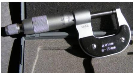
Gambar 6. Mikrometer Sekrup
