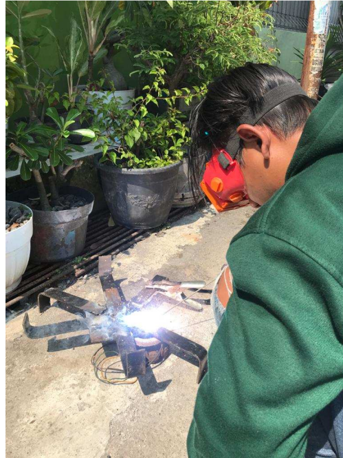
Gambar 4.14 Pengelasan kaki roda
