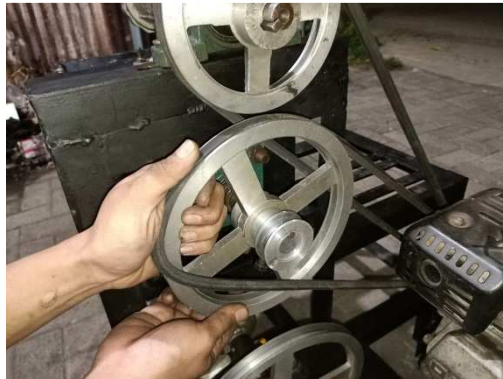
Gambar 4.27 Pemasangan puli 8 inci pada pengaduk
