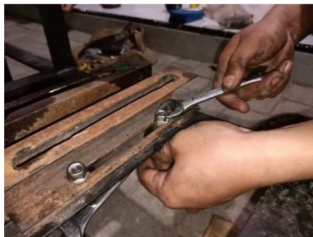
Gambar 4.14 Pemasanganudukan mesin bensin
