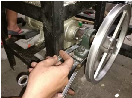
Gambar 4.24 Pemasanganudukan puli pencetak pelet
