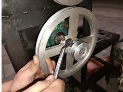
Gambar 4.23 Pemasangan puli 2 inc pengaduk
