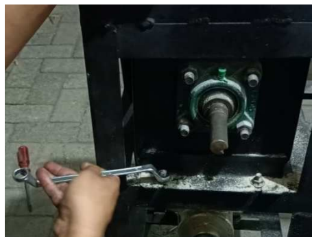
Gambar 4.19 Pemasangan mur 2 buah pada mesin pengaduk
