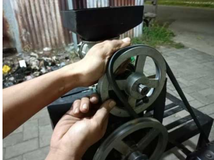
Gambar 4.26 Pemasangan puli 6 inci penggiling daging
