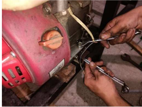
Gambar 4.15 Pemasangan mesin bensin GX160
