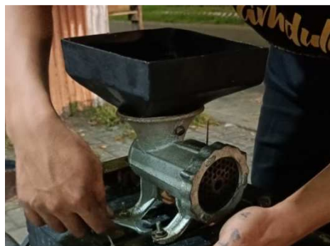
Gambar 4.17 Pemasangan mesin penggiling daging
