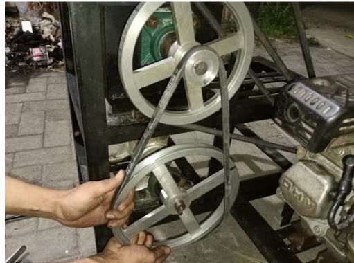
Gambar 4.28 Pemasangan puli 2 inci dan 10 inci
