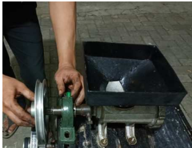
Gambar 4.21 Pemasangan puli dan bearing
