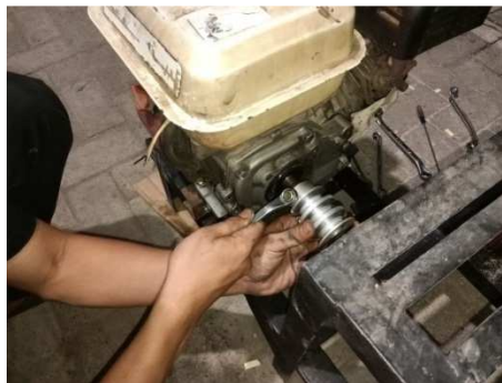
Gambar 4.16 Pemasangan puli 2 inchi 3 jalur
