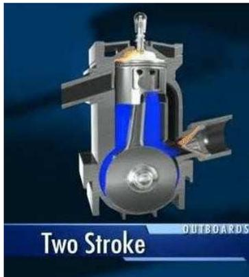
Gambar 2. Motor 2 Langkah
