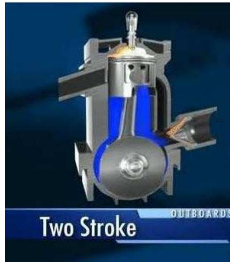
Gambar 2.2 Motor 2 Langkah
