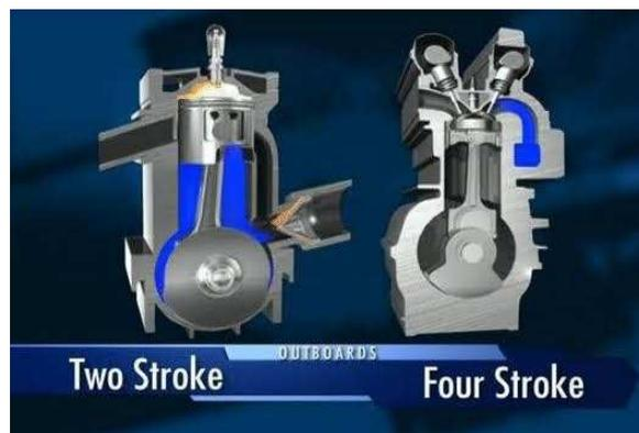
Gambar 2.4 Prinsip Kerja Mesin Bensin
