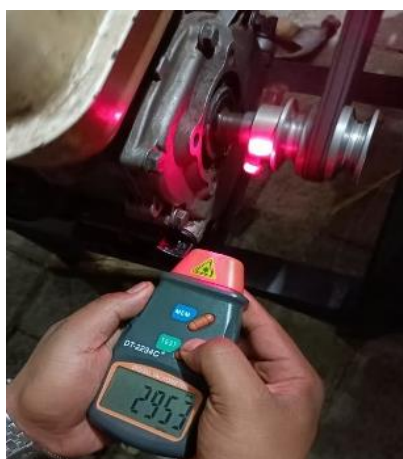
Gambar 3. 16 Pengukuran rpm pada mesin penggerak
