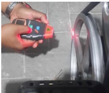
Gambar 3. 19 Pengukuran rpm pada pencetak pelet
