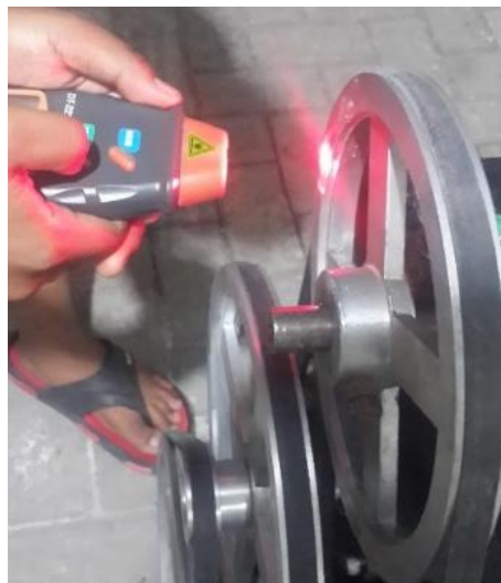
Gambar 3. 17 Pengukuran rpm pada penggiling daging
