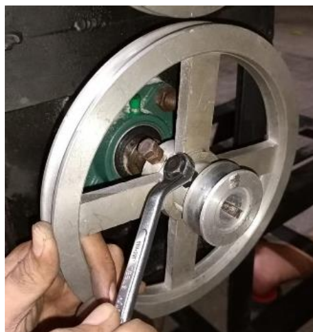
Gambar 3. 14 Pemasangan puli 10 inchi pada pengaduk bahan baku
