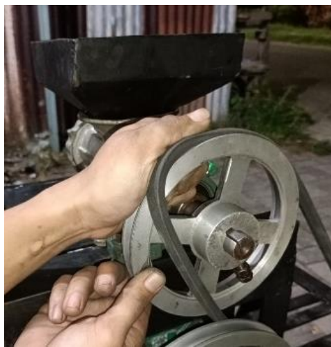
Gambar 3. 13 Pemasangan puli 8 inchi pada penggiling
