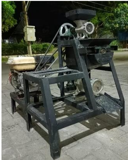
Gambar 3. 6 Mesin pencetak pelet ikan 3 in 1
