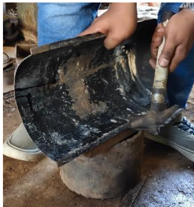
Gambar 4. 14 Proses buat penyangga laci output pengaduk
