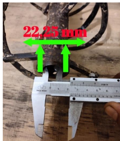
Gambar 4. 50 Diameter dalam pipa besi
