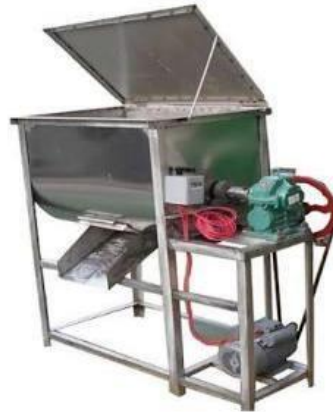
Gambar 2. 2 Mesin pengaduk horisontal ( Rekatehnikindo, 2015 )
