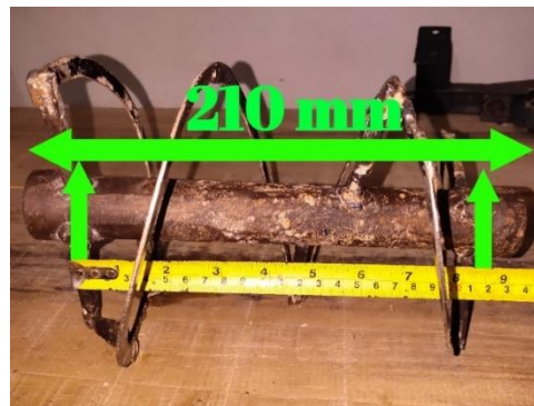
Gambar 4. 46 Panjang besi tulang depan dan belakang
