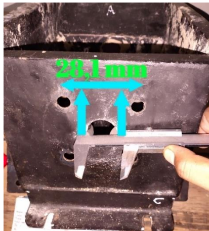
Gambar 4. 37 Diameter lubang poros belakang wadah pengaduk
