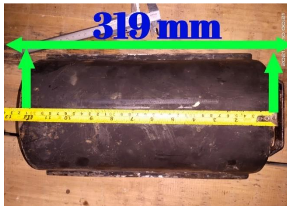
Gambar 4. 40 Panjang laci output pengaduk
