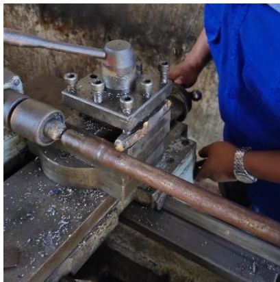
Gambar 4. 19 Proses bubut besi poros
