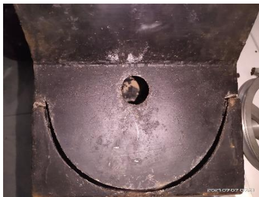
Gambar 4. 17 Lubang poros pengaduk bagian depan
