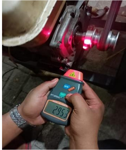
Gambar 3. 35 pengukuran 3000 Rpm motor penggerak
