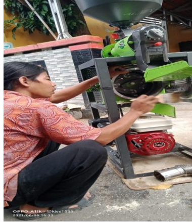
Gambar 4.6 Pembersihan mesin penepung. (Isbandi ,2021 )
