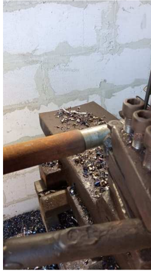
Gambar 4.10 Pembubutan Permukaan (Sumber: Dokumentasi 2021)
