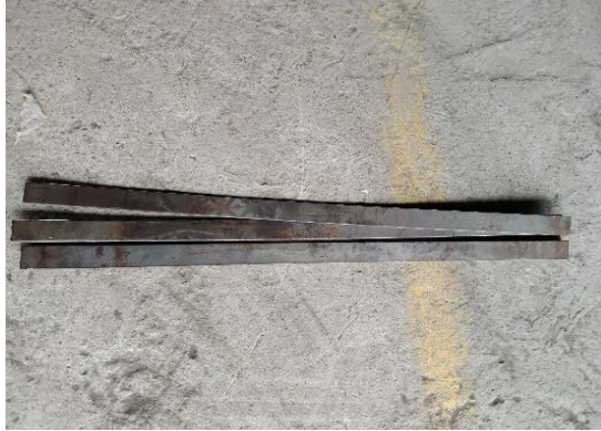
Gambar 3. 5 besi plat ukuran panjang 800 mm, lebar 35 mm dan tebal 3 mm (Dokumentasi, 2021)
