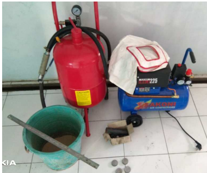
Gambar 3.11 Persiapan Alat Sandblasting Sumber : (Dokumen, 2021)
