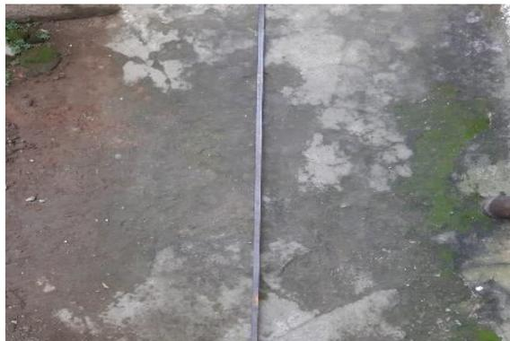
Gambar 3.5 Besi Nako ukuran panjang 800 mm dan lebar 6x6 mm
