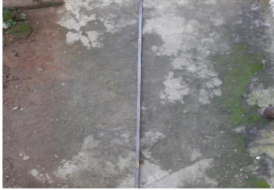
Gambar 3.8 Besi Nako ukuran panjang 800 mm dan lebar 6x6 mm
