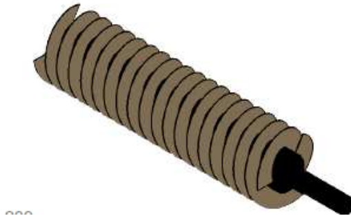
Gambar 4. Poros Turbin Ulir ( Sumber : Dokumentasi, 2020 )
