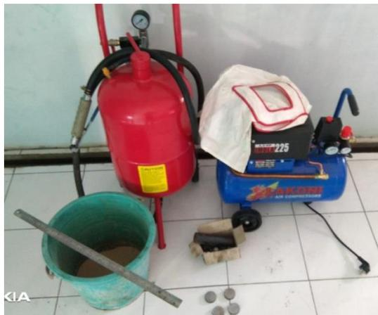
Gambar 3.11 Persiapan Alat *Sandblasting*
