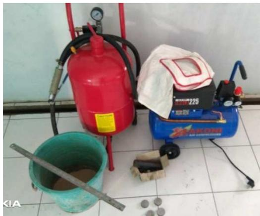
Gambar 3.11 Persiapan Alat *Sandblasting*
