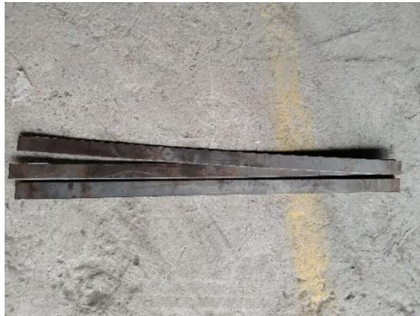
Gambar 3.5 besi plat ukuran panjang 80cm, lebar 3cm dan tebal 3mm
