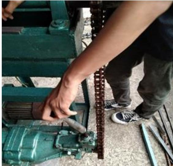
Gambar 3.10 memasukan kecepatan gigi gearbox
