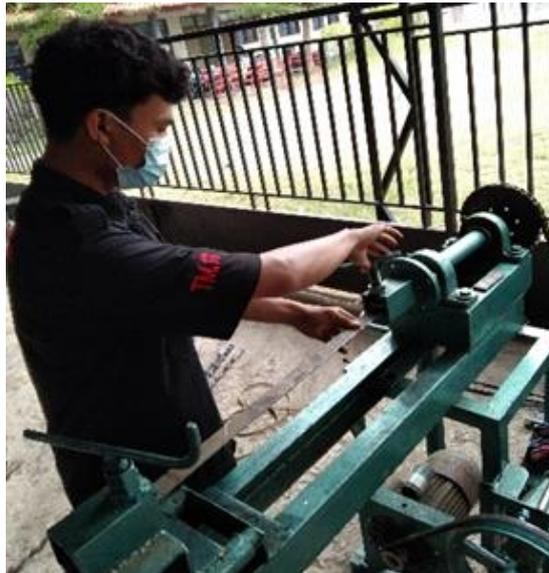
Gambar 3.9 pemasangan besi plat pada mesin pemuntir besi
