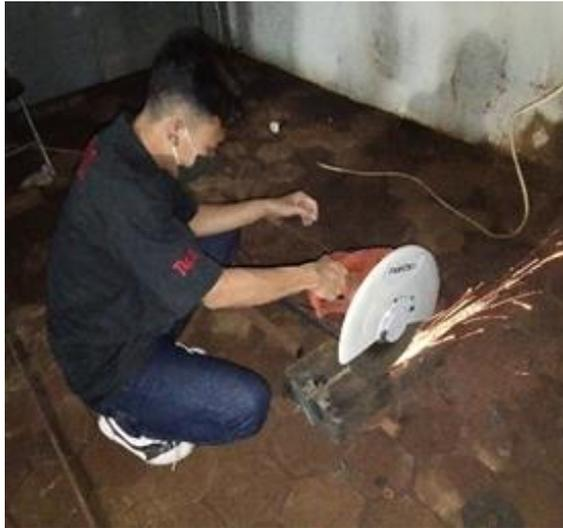
Gambar 3.8 pemotongan plat
