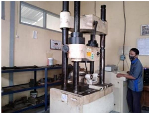
Gambar 2.3 Proses Pengujian Tarik
