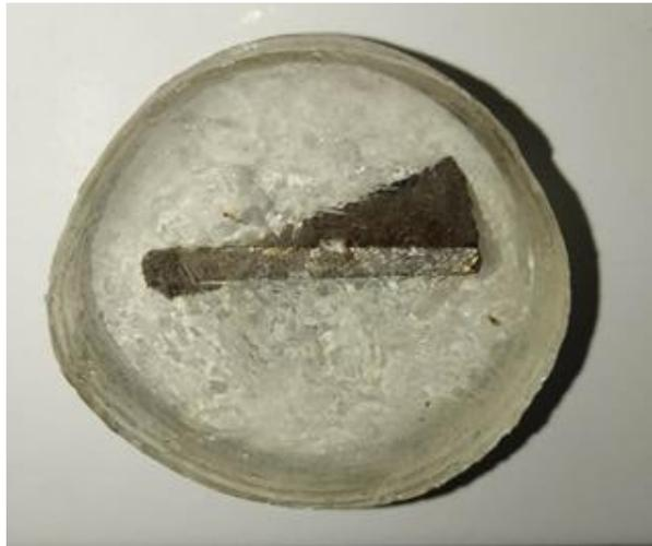
Gambar 3.13 potongan material yang akan dimikrostruktur
