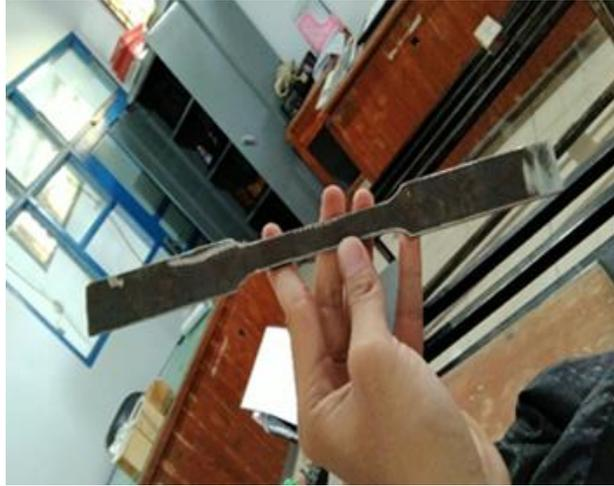
Gambar 2.2 Spesimen Uji Tarik
