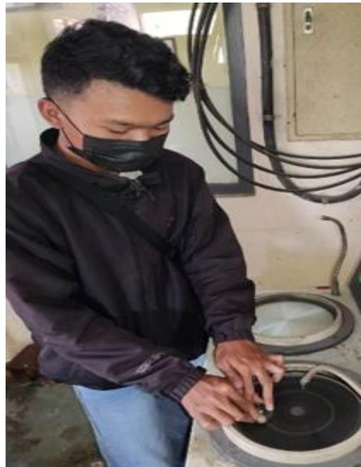
Gambar 3.17 proses pengamplasan menggunakan amplas halus
