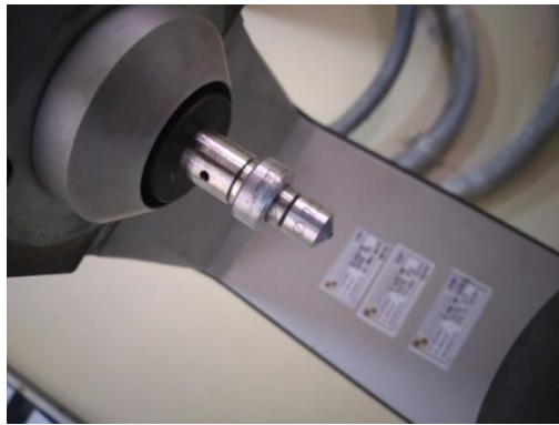
Gambar 3. 18 Pemasangan Bola Identor Sumber : (Dokumentasi, 2021)
