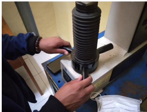
Gambar 3. 23 Memutar Dudukan Bawah Sumber : (Dokumentasi, 2021)
