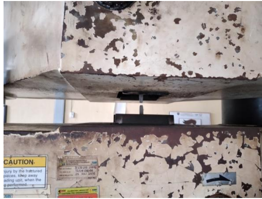
Gambar 3. 16 Benda Patah Sumber : (Dokumentasi, 2021)
