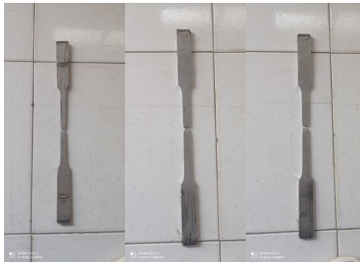
Gambar 3. 17 Hasil Specimen Putus Sumber : (Dokumentasi, 2021)
