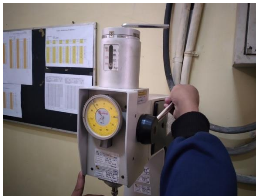
Gambar 3. 21 Memberi Beban Tekanan Benda Uji Sumber : (Dokumentasi, 2021)
