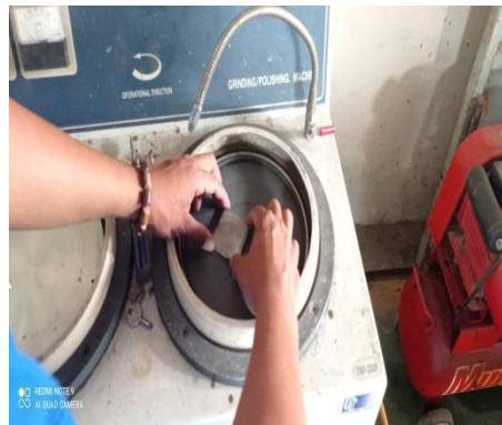
Gambar 3. 14 Proses Pengamplasan Sumber : (Dokumentasi, 2021)
