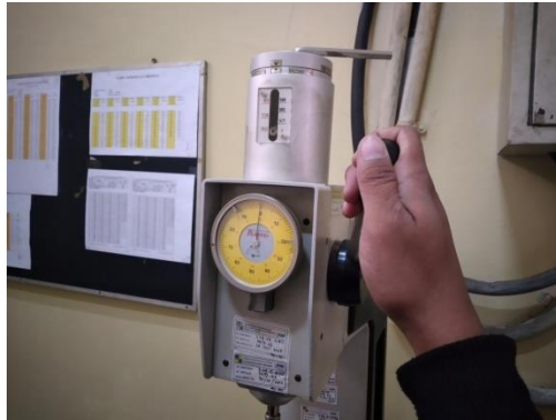
Gambar 3. 22 Melepas Beban Tekanan Sumber : (Dokumentasi, 2021)
