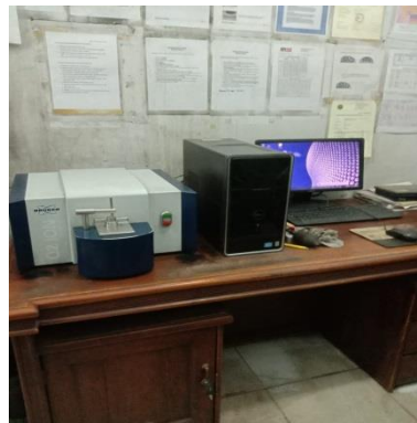
Gambar 3. 4 Alat Uji Komposisi Sumber : (Dokumentasi, 2021)
