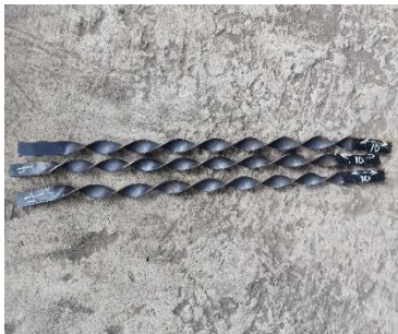
Gambar 12 Hasil puntir 4 kali puntiran
