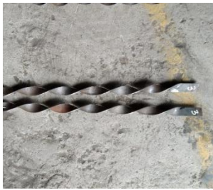
Gambar 10 Hasil puntir 3 kali puntiran
