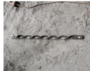
Gambar 14 Hasil puntir 5 kali puntiran
