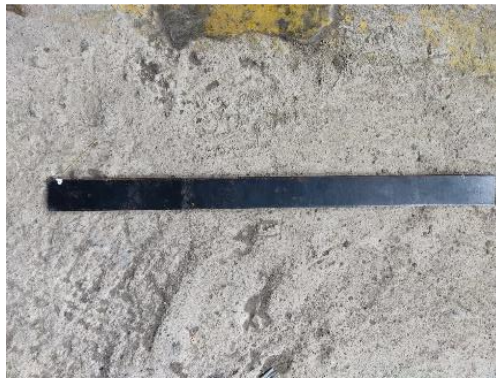
Gambar 4.1 Material Raw atau Asli Besi Plat ST 37 Sumber: (Dokumentasi, 2021)
