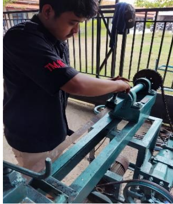
Gambar 3.10 Pasang besi plat Sumber : (Dokumentasi, 2021)
