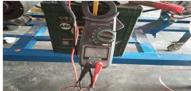
Gambar 3.18 mengukur tegangan baterai
