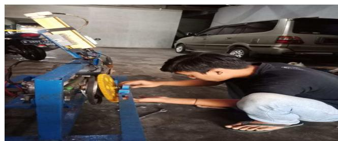
Gambar 3.14 memasang *pulley*yang akan diuji agar senter
