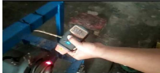
Gambar 3.16 menghitung putaran mesin penggerak
