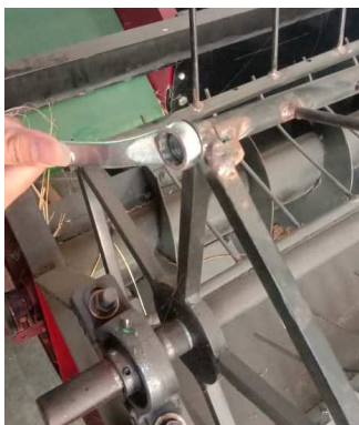
Gambar 9. Pengencangan Jari – jari
