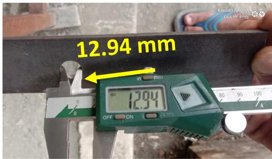
Gambar 4.23 Pengecekan lingkaran bracket
