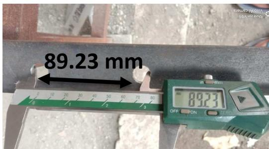
Gambar 4.25 Pengecekan jarak lingkaran bracket
