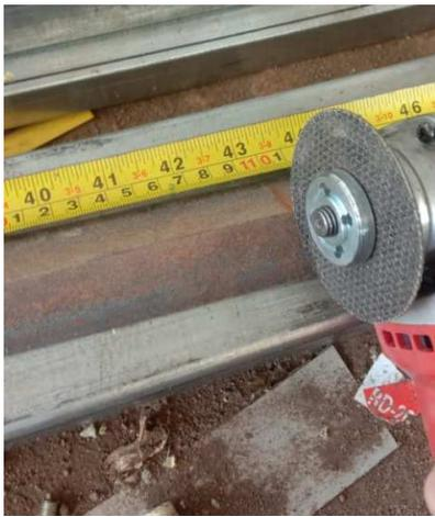
Gambar 4.7 Proses pemotongan dudukan bracket
