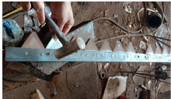
Gambar 4.11 Proses perakitan pisau pemotong
