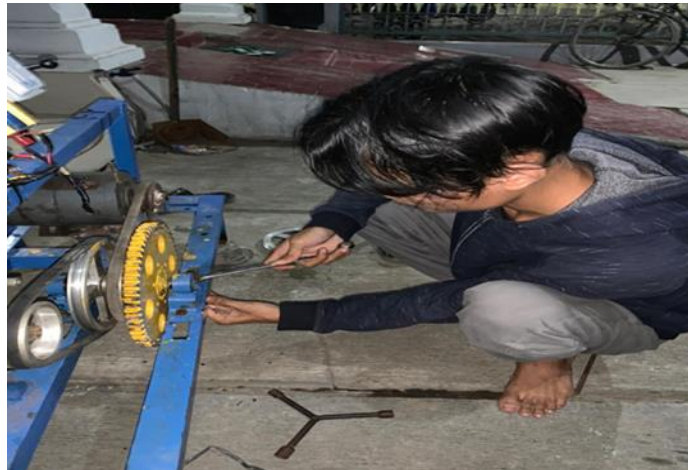
Gambar 3.13 Pemasangan ass penghubung dan pulley pada mesin (Dokumentasi, 2021)
