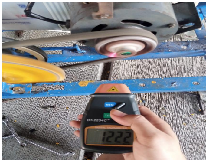
Gambar 3.18 Mengukur putaran rpm motoran atau dinamo (Dokumentasi, 2021)
