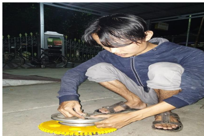
Gambar 3.12 Pemasangan pulley pada ass penghubung (Dokumentasi, 2021)
