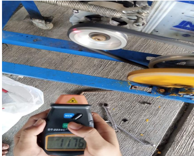
Gambar 3.19 Mengukur putaran Rpm pada alternator (Dokumentasi, 2021)
