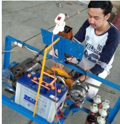
Gambar 3.13 Pemasangan baterai, pulley dan v-belt . (Dokumentasi, 2021)
