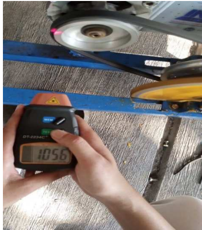
Gambar 3.17 pengukuran putaran mesinaltenator. (Dokumentasi, 2021)
