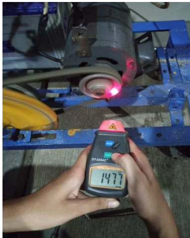
Gambar 3.16 pengukuran putaran mesin dinamo. (Dokumentasi, 2021)
