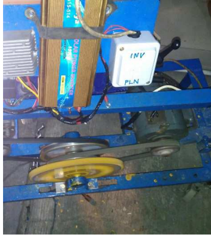
Gambar 3.15 mengarahkan saklar ke Inverter untuk menghasilkan beban. (Dokumentasi, 2021)
