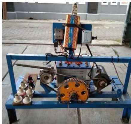
Gambar 3.14 menghidupkan mesin menggunakan pln untuk starter awal. (Dokumentasi, 2021)
