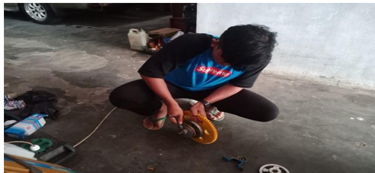
Gambar 3.14 memasang pulley yang akan diuji agar senter
