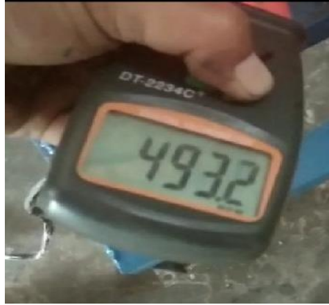
Gambar 3.16 menghitung putaran Alternator
