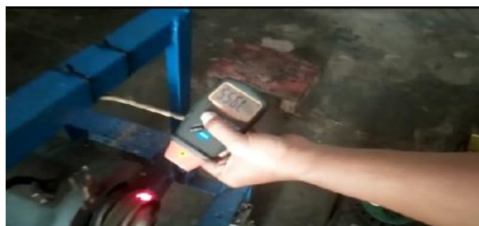
Gambar 3.15 menghitung putaran mesin penggerak
