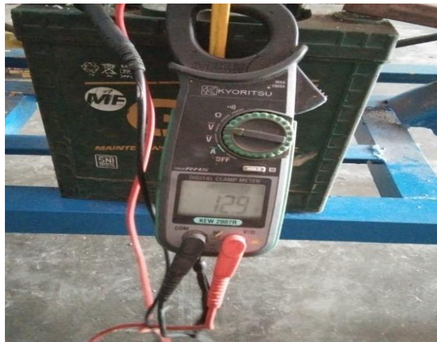
Gambar 3.17 mengukur tegangan baterai
