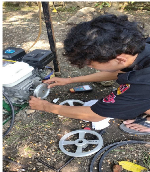
Gambar 3.10. Pemasangan Puli Diameter 5 inch
