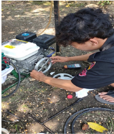
Gambar 3.11. Pemasangan Puli diameter 7 inch
