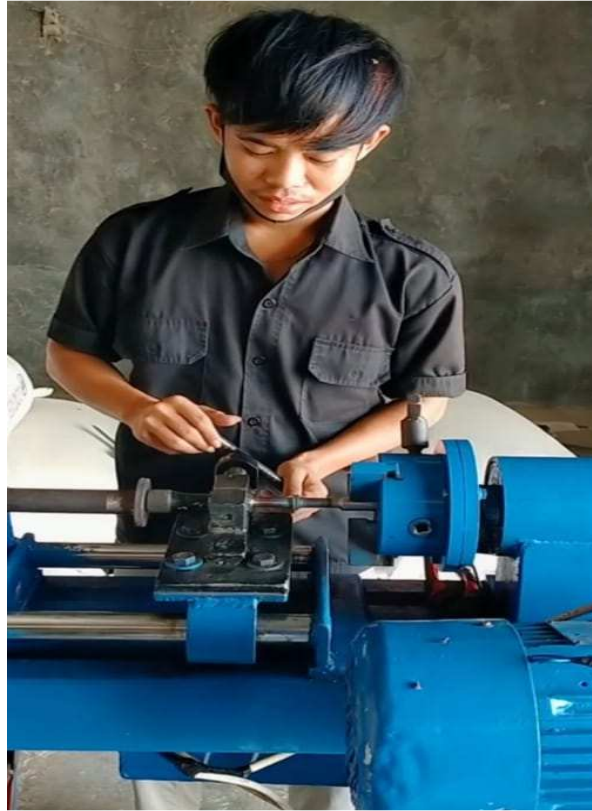
Gambar 3.19 Pelepasan benda setelah dilas
