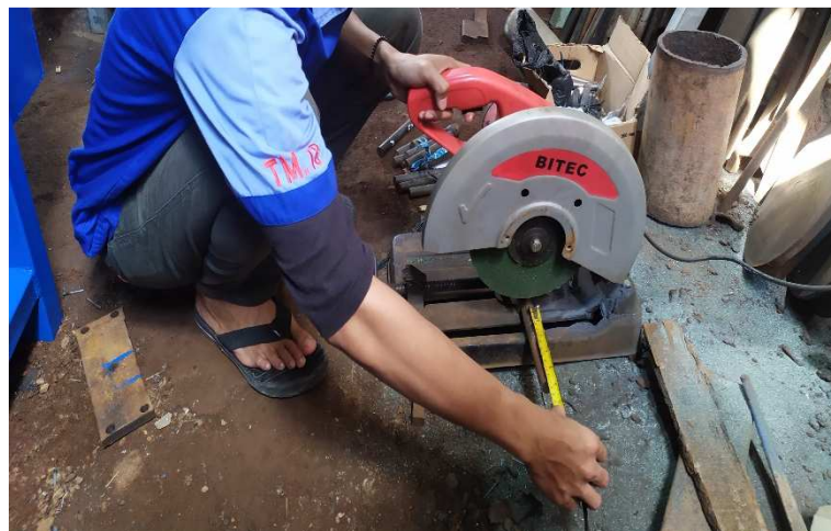
Gambar 3.12 Proses pemotongan besi aisi 1045
