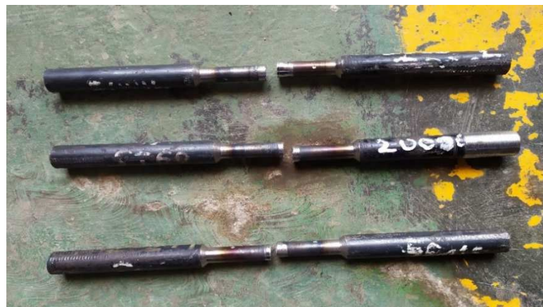
Gambar 3.24 Hasil Pengujian Tarik
