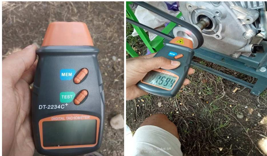
Gambar 4. 4 Pengukuran Rotasi Mesin
