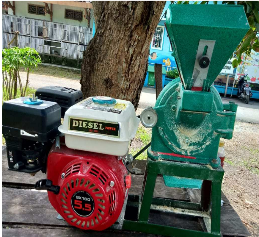
Gambar 2. 1 Mesin disk mill FFC 15 ( Dokumentasi, 2021 )
