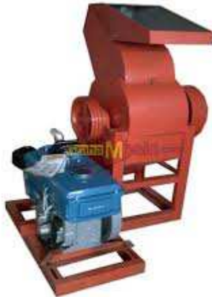
Gambar 2.5 Mesin Pencacah Plastik (Syamsiro dkk, 2016).
